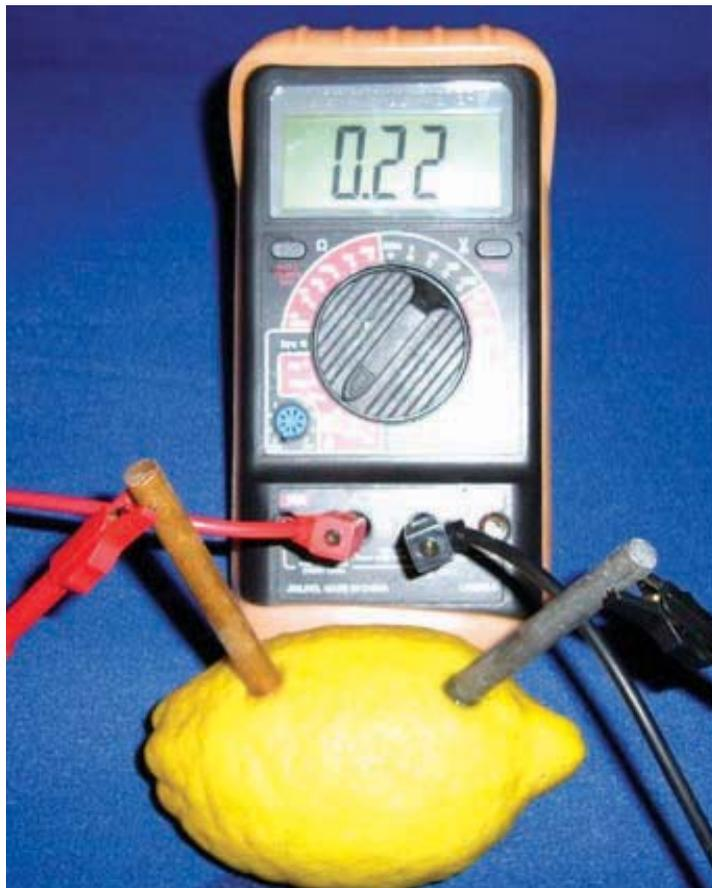
*A l'aide d'un citron et deux tiges métalliques l'une en cuivre et l'autre en zinc, on peut réaliser une pile électrochimique.*
