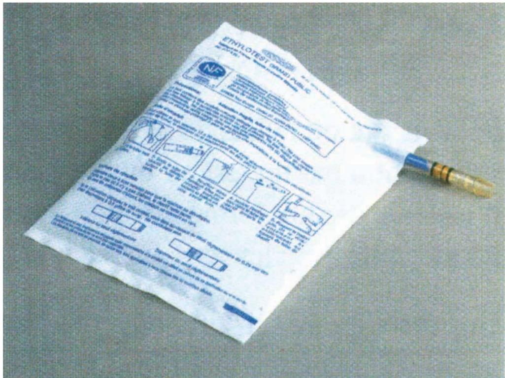
*L'éthylotest (ou alcootest) est un dispositif qui permet de détecter la présence de vapeurs d'éthanol dans l'air expiré par une personne ayant consommée une boisson alcoolisée.
